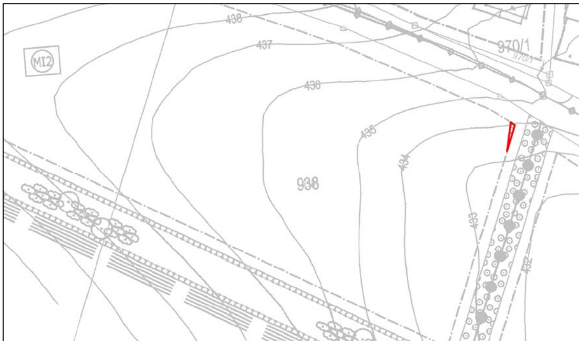
Abbildung 11: Lageplan mit Kennzeichnung des Bereichs, in denen keine Immissionsorte im Sinne der TA Lärm auf Höhe des 2. Obergeschosses zulässig sind
